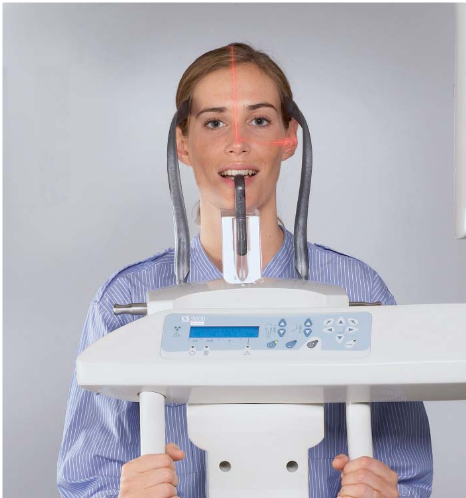
Figura 11 - Guías de posicionamiento; observe la varilla de mordida, las guías de cabeza y la luz incidente
